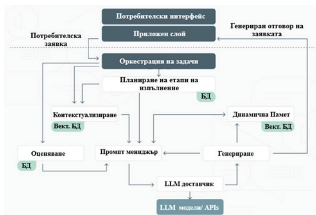
Фиг. 1. Модулна архитектура на разработената платформа за допълнително обучение на големи езикови модели
