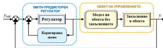
Фиг. 2. Структура на система за управление на SISO обект с предикторен регулатор на Smith
