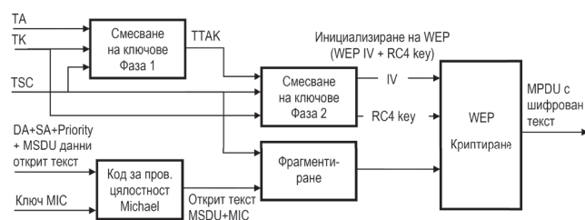
Фиг. 4. Процес криптиране в TKIP (от стандарт IEEE Std 802.11™-2012)
