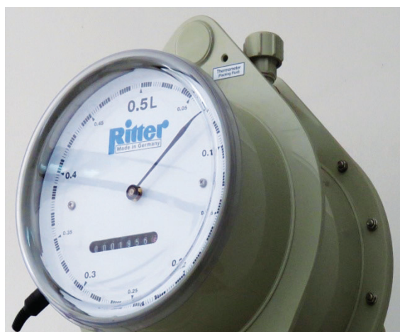
Фиг. 2. Газов дебитомер от мокър барабанен тип
